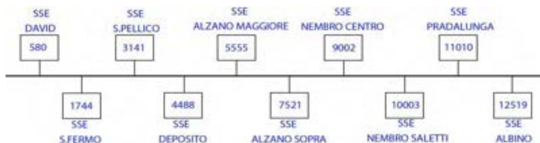
Figura 3. Sottostazioni di alimentazione della linea
