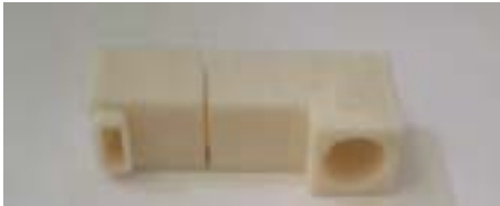
Figura 12. Foto dell'uscita del nebulizzatore. Questo sistema con beccuccio è stato realizzato per i supporti da 20 cm 2
