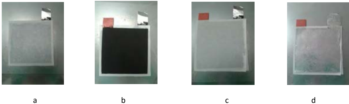
Figura 3. Sequenza di formazione della batteria: a) fotografia del separatore sovrapposto al primo elettrodo positivo, b) aggiunta dell'elettrodo bipolare anodico, c) aggiunta del secondo separatore, d) completamento della cella con il secondo elettrodo positivo
