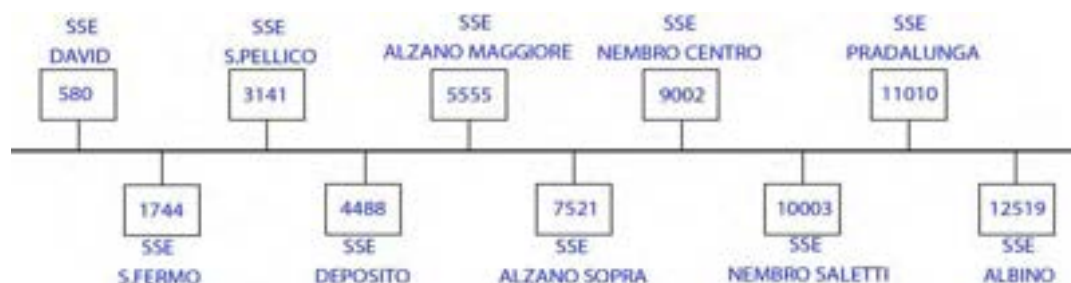
Figura 2. Sottostazioni di alimentazione della linea
