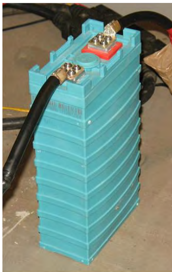
Figura 6. Rigonfiamento della cella 1 dopo circa 70 cicli
