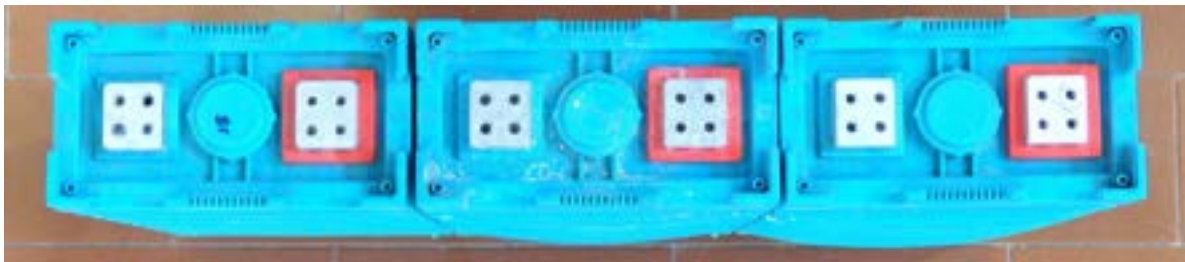
Figura 9. Deformazione delle celle sottoposte ai cicli di prova
