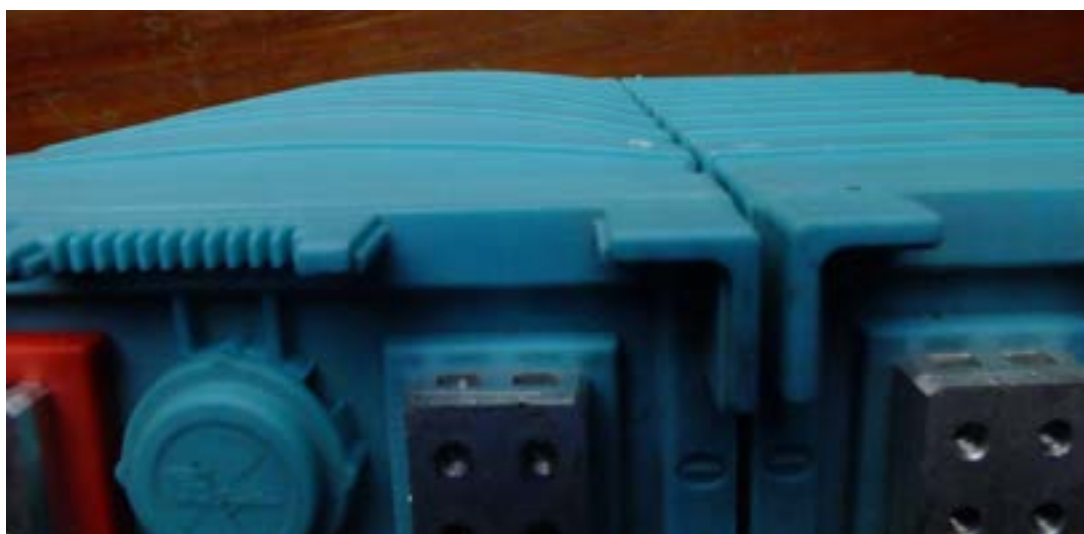
Figura 8. Deformazione del contenitore della cella in prova (sinistra) e confronto con una cella integra
