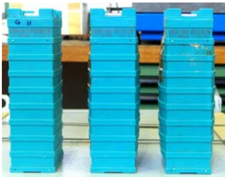
Figura 10. Deformazione delle celle sottoposte ai cicli di prova
