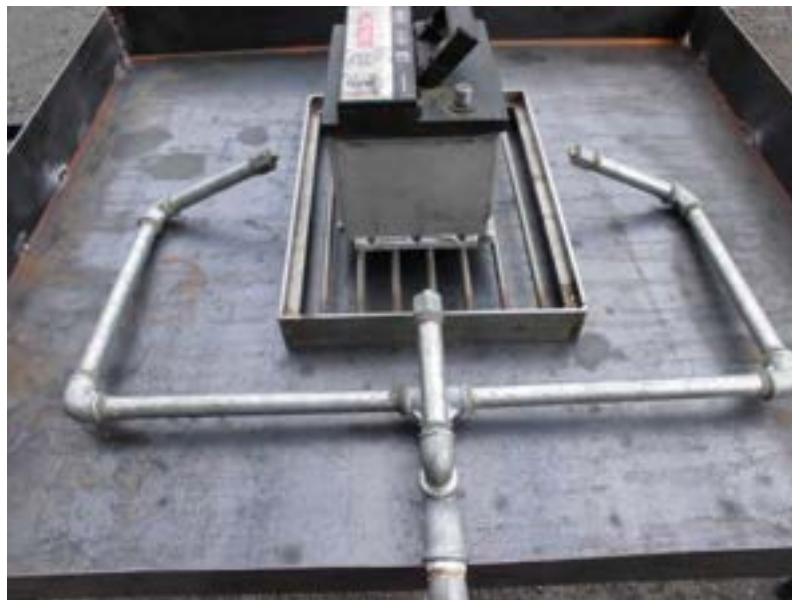
Figura 3. Vista del banco prova incendio
