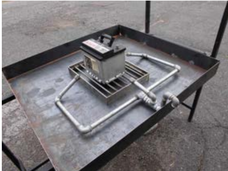
Figura 2. Vista laterale del banco prova incendio
