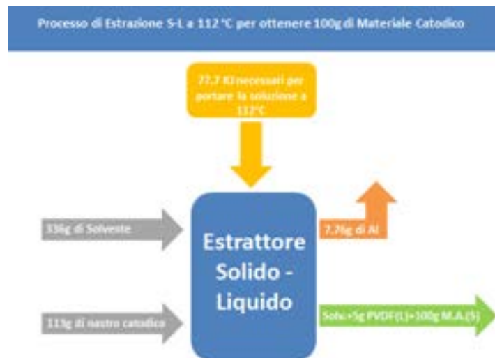
Figura 4. Processo di solvatazione a 112^{\circ}\text{C} per ottenere 100 grammi di materiale catodico.
