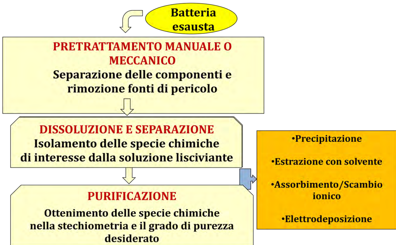
Figura 4. Processo idrometallurgico per il recupero di materiali da batterie esauste o in generale da RAEE
