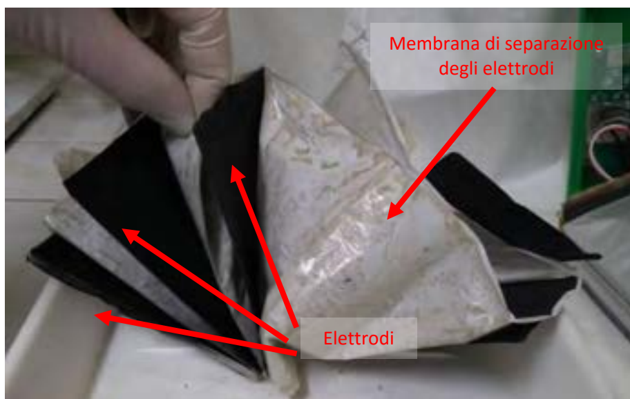
Figura 23. Separazione degli elettrodi, sui quali è depositato il materiale elettrolitico
