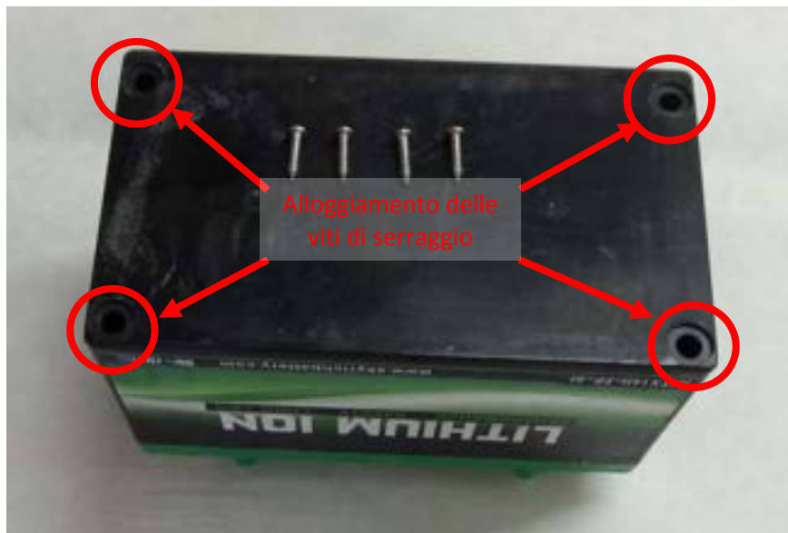
Figura 6. Apertura della batteria: alloggiamento delle quattro viti di serraggio della parte superiore all'involucro della batteria
