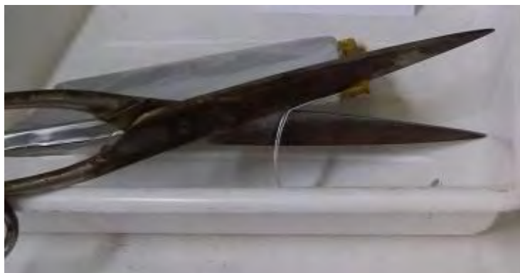
Figura 20. Taglio del lato inferiore (opposto agli elettrodi) dell'involucro argentato esterno della cella
