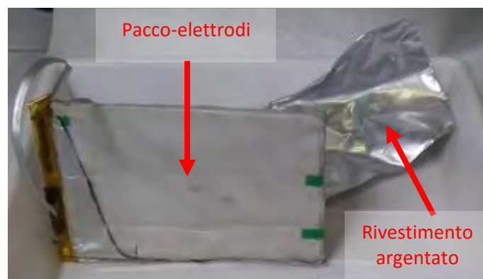
Figura 21. Contenuto interno della cella
