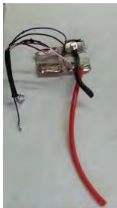
Figura 14. Taglio dei terminali di collegamento tra pacco batterie e morsetti: a sinistra, pacco batterie con i terminali collegati, a destra, terminali disassemblati
