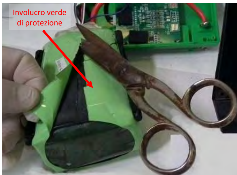
Figura 13. Taglio e rimozione dell'involucro di protezione verde
