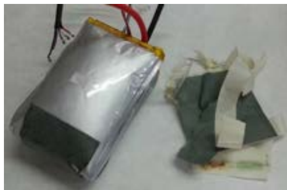
Figura 17. Rimozione dei nastri adesivi
