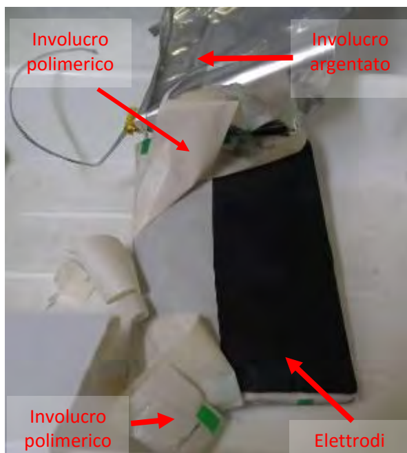
Figura 22. Apertura dell'involucro polimerico ed estrazione degli elettrodi
