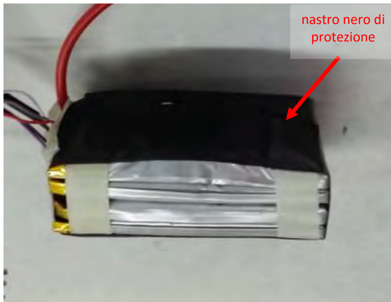
Figura 15. Rimozione dell'involucro nero di protezione
