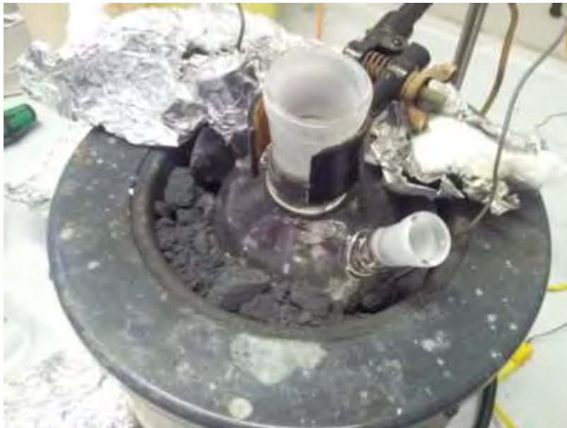
Figura 15. Sistema sperimentale allestito per verificare e confrontare la stabilità delle miscele di sali
