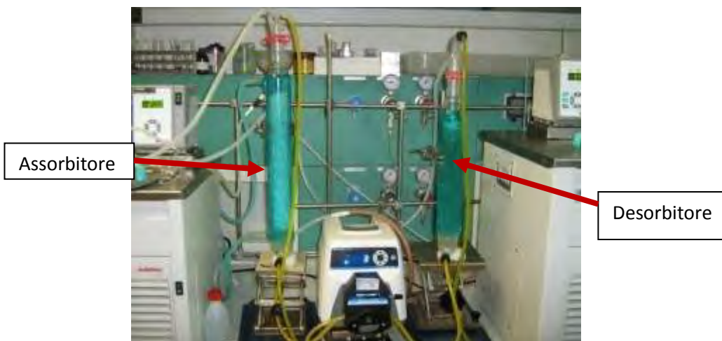
Figura 7. Sistema di assorbimento e desorbimento di CO 2 in continuo. La temperatura delle due colonne incamiciate è controllata mediante la circolazione di glicol etilenico termostatzato
