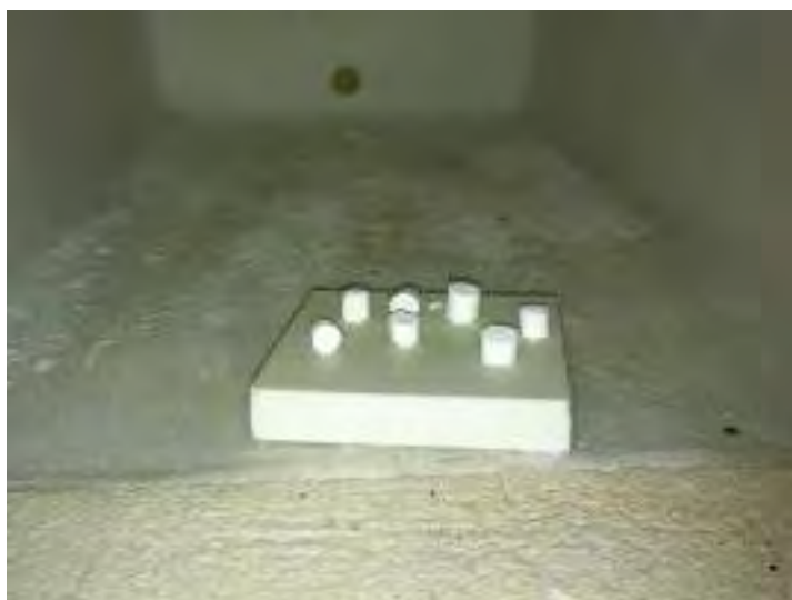
Figura 11. Fotografia dei pellets al termine della sinterizzazione
