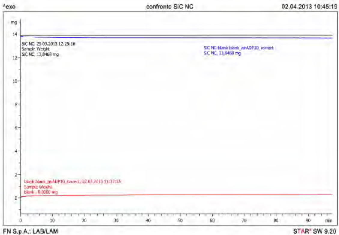
Figura 8. Confronto dei termogrammi del SiC non catalizzato con sottrazione del bianco manuale e sottrazione automatica
