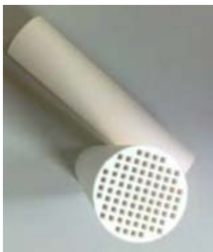
Figura 12. Campioni di filtro ceramico estrusi
