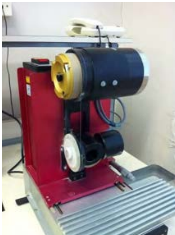
Figura 22. Attrezzatura con filo diamantato per il taglio dei campioni (fonte ENEA)
