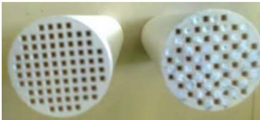
Figura 14. A sinistra campione non trattato, a destra campione con fori "chiusi" in modo alterno con cemento FN01
