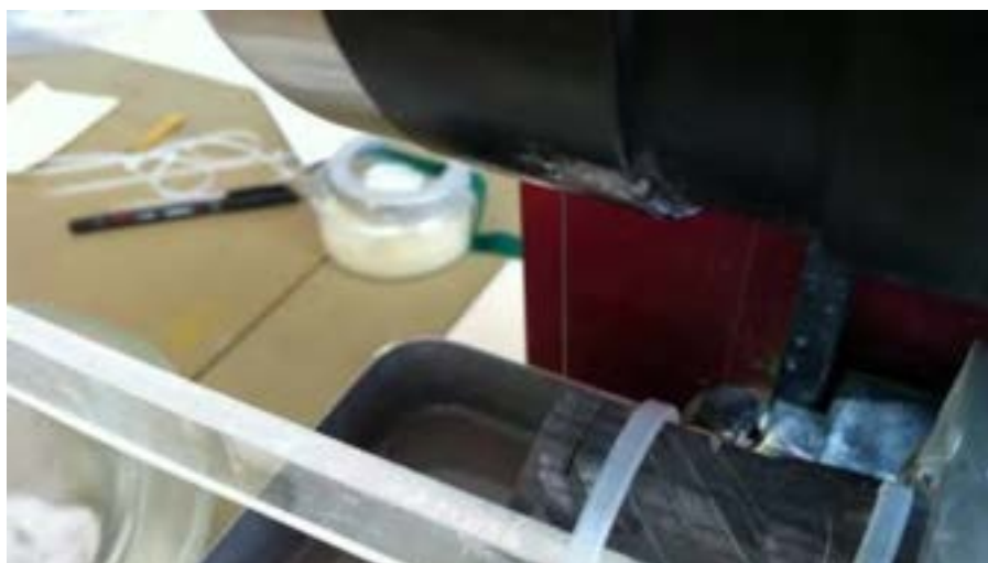
Figura 23. Particolare dell'operazione di taglio su un filtro in SiC e dell'attrezzatura di bloccaggio (fonte ENEA)
