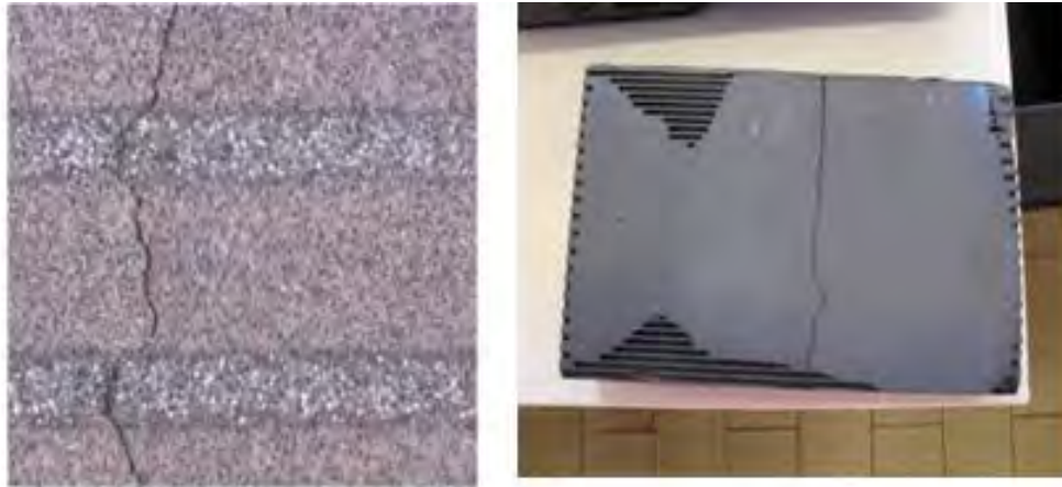
Figura 12. Crepe originatesi per shock termico
