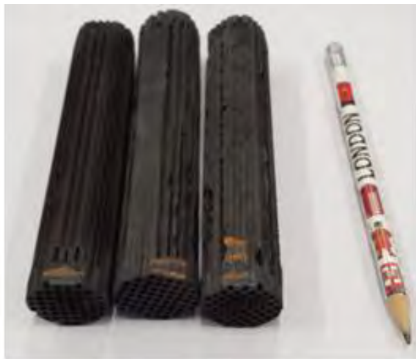
Figura 13. Filtri realizzati per le prove allo scarico della caldaia in ENEA
