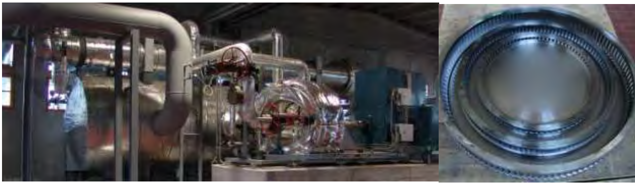
Figura 7. ORC prodotto da Exergy, con turbina a geometria radiale
