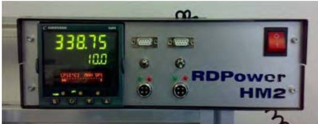
Figura 12. Strumento di controllo autoclavi con PLC programmabile e gestibile da PC
