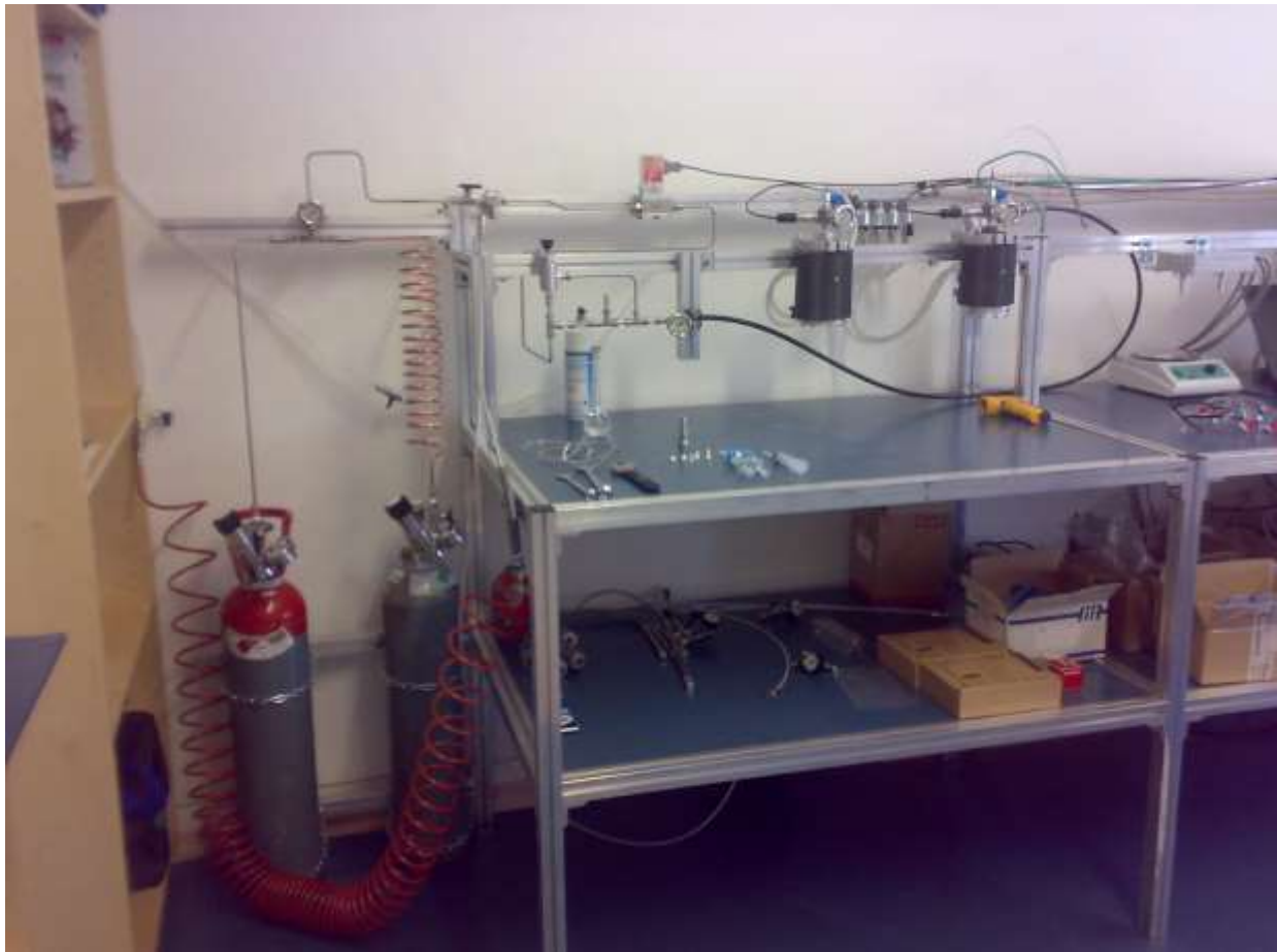
Figura 4. Realizzazione presso la RDPower del prototipo descritto, linea di carico più 2 autoclavi
