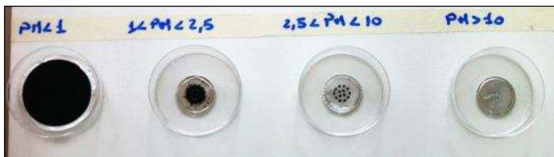
Figura 22. Filtri dell'impattore a seguito del campionamento (prova 26/07/2013)
