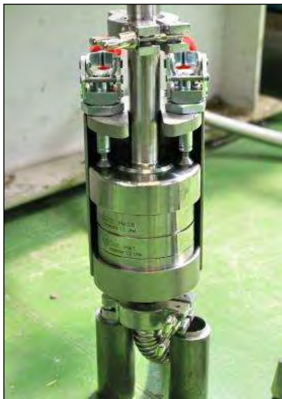
Figura 11. Impattore per la misura gravimetrica del particolato
