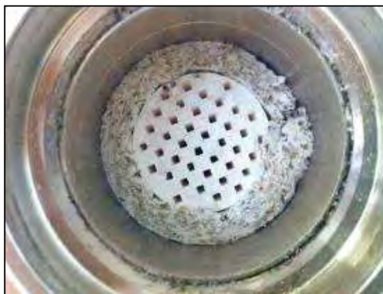
Figura 19. Filtro ceramico inserito nel manicotto
