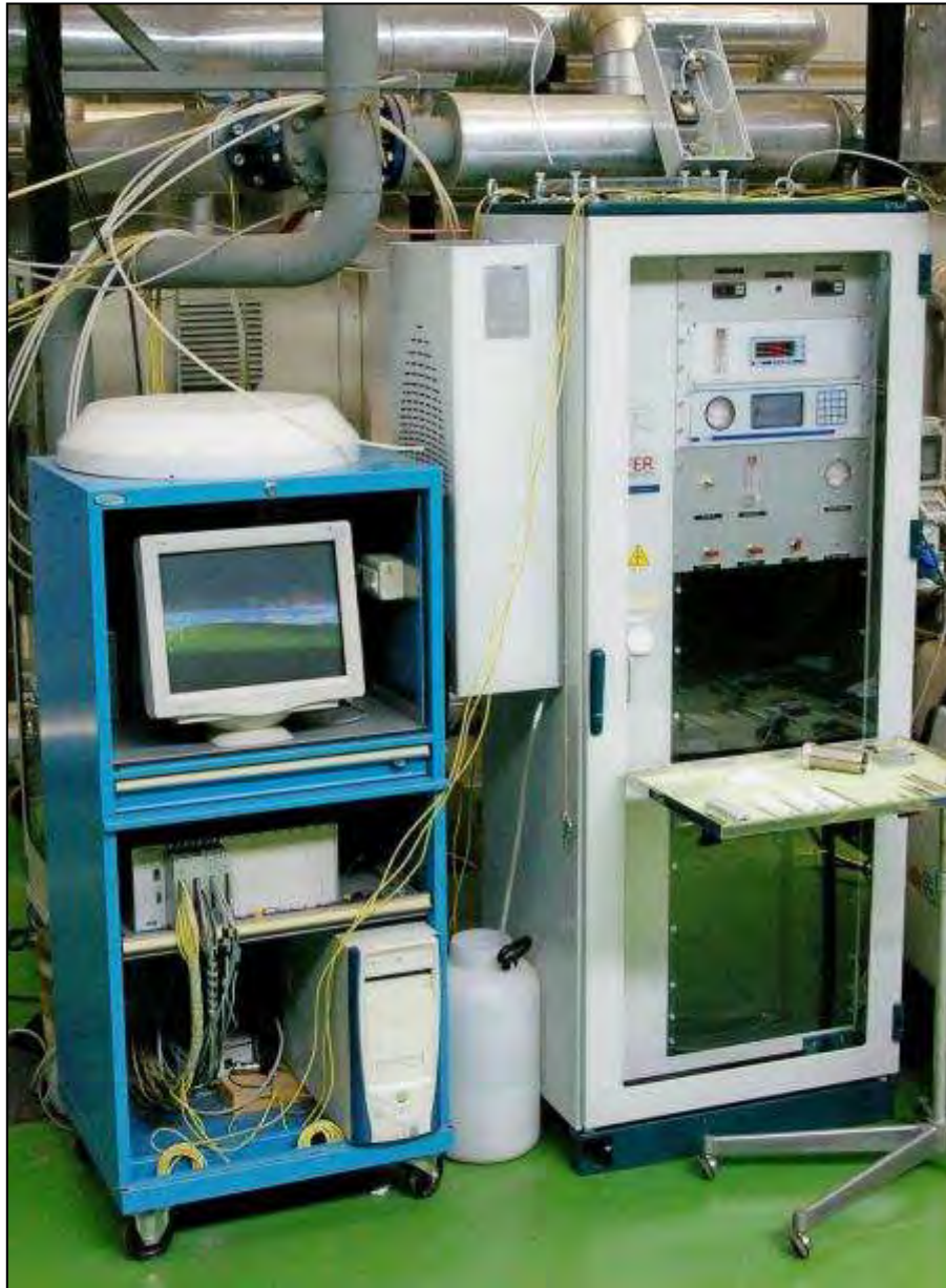
Figura 13. Sistema di analisi dei gas ad armadio
