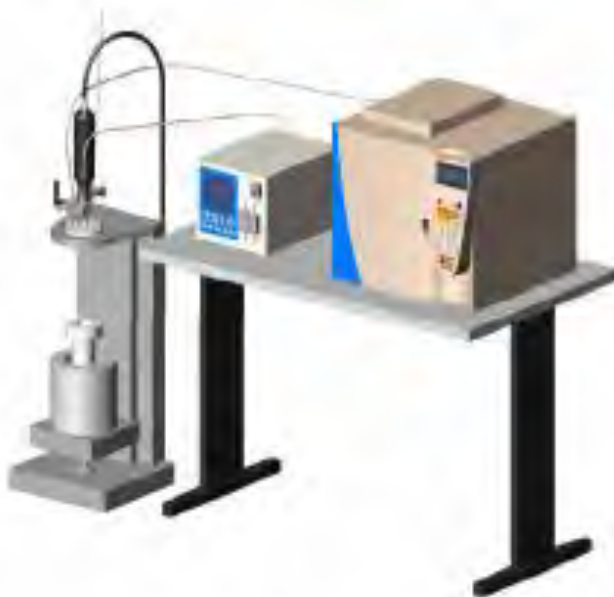
Figura 4.2 Rendering dell'apparato sperimentale corredato dalla valvola tarata, dal sistema di alimentazione in continuo AGP Dionex e dal GC per la misurazione on-line dei gas
