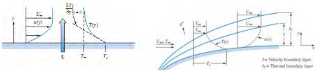
Figura 14: Strato limite termico e cinematico
