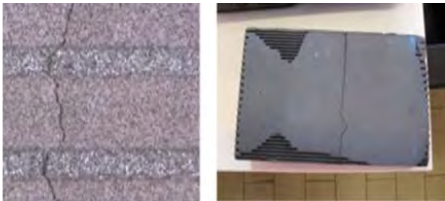
Figura 3: crepe originatesi per shock termico
