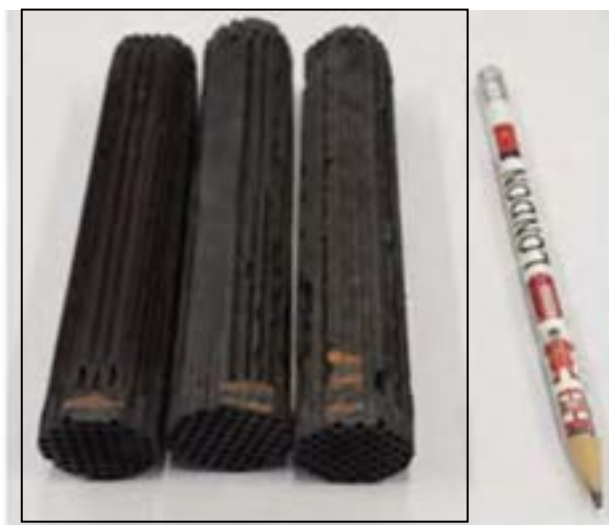
Figura 5. Prototipi in scala di laboratorio di filtri wall flow in SiC
