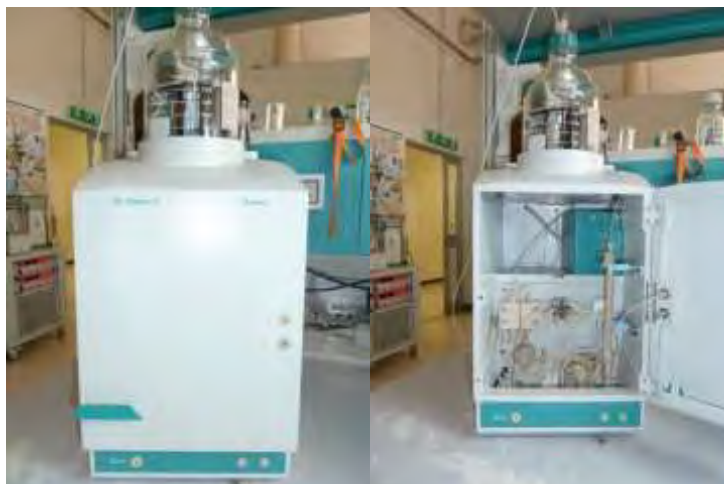
Figura 4. Sistema di cromatografia ionica per la determinazione quantitativa di nitrati e nitriti
