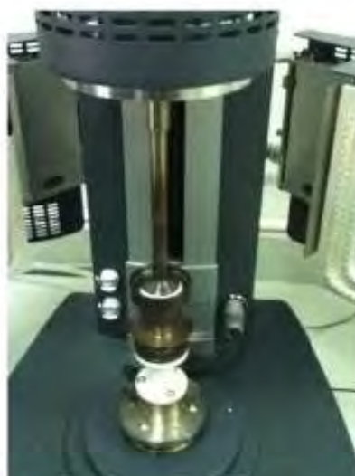
Figura 2. Reometro - Particolare dello statore (sotto) e del rotore (sopra) con, fra i due elementi, il campione
