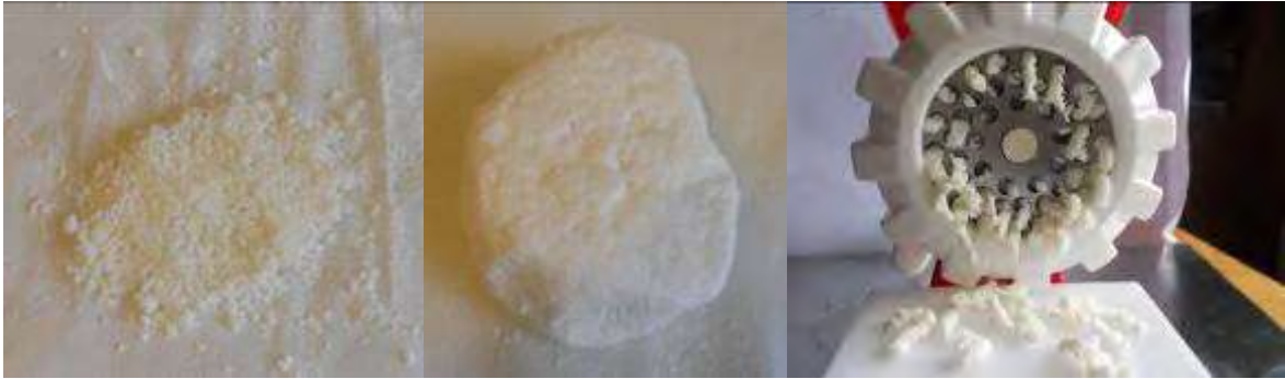
Figura 9. A sinistra polvere granulata, al centro massa morbida da estrudere, a destra trafilatura dei pellets
