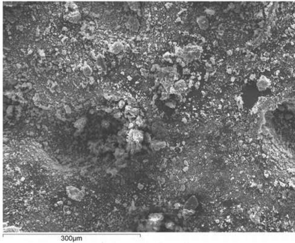
Figura 2. Immagine al SEM a 200 X polvere ossido misto Mg/Al (prima porzione di campione)
