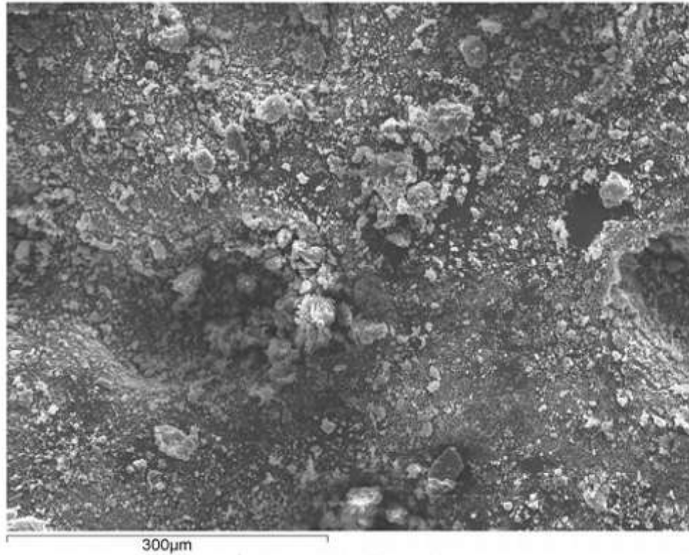
Figura 3. Immagine al SEM a 200 X polvere ossido misto Mg/Al (seconda porzione di campione)
