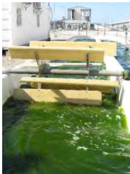
Figura 3. Sistema di agitazione dell'impianto pilota Seabiotic
