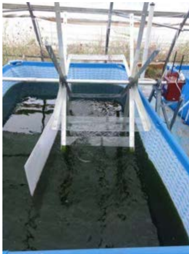
Figura 15. foto dell'agitatore a pale funzionante in vasca
