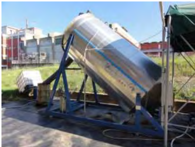
Figura 32. Digestore anaerobico sperimentale da 6 m 3 presso C.R. ENEA Casaccia
