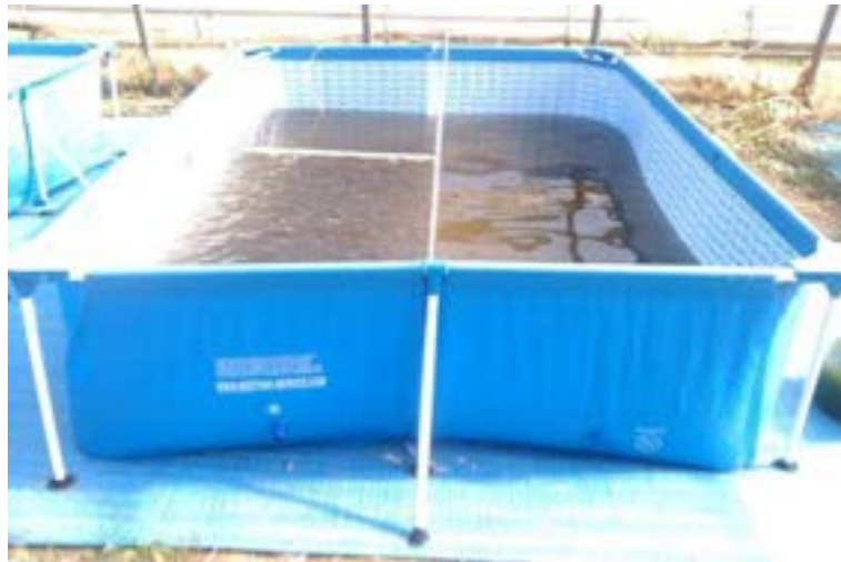
Figura 19. Vasca con digestato appena immesso
