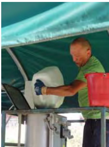
Figura 33. Alimentazione del digestore con biomassa microalgale raccolta dalle vasche sperimentali
