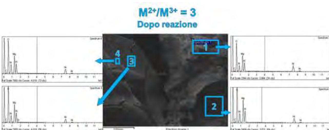
Figura 11. Immagine SEM registrata in una zona del campione con M^{2+}/M^{3+} = 3 con i relativi spettri EDS effettuati in diverse zone
