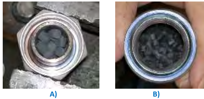
Figura 9. Pellets di catalizzatore G1-85 a fine test con miscela di gas 5: A) all'uscita del reattore di metanazione, B) campione per le caratterizzazioni analitiche sull'integrità del catalizzatore.
