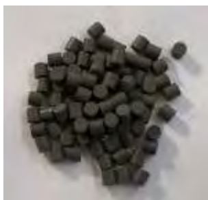
Figura 4. Pellets di catalizzatore G1-85 T 5x5 nella forma inattiva
