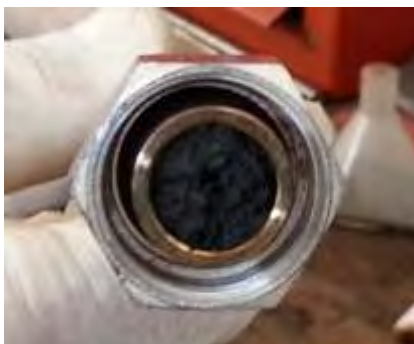
Figura 5. Reattore di metanazione: dettaglio sul residuo carbonio prodotto a fine prova con miscela 3
