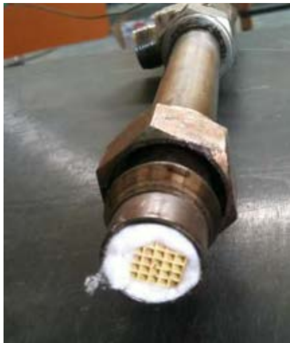
Figura 35. Monolite con V_2O_5 per l'ossidazione selettiva dell' H_2S
