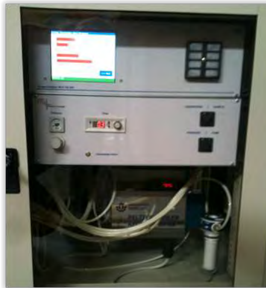
Figura 4. Immagine dell'analizzatore di processo utilizzato per la misura continua della composizione del biogas
