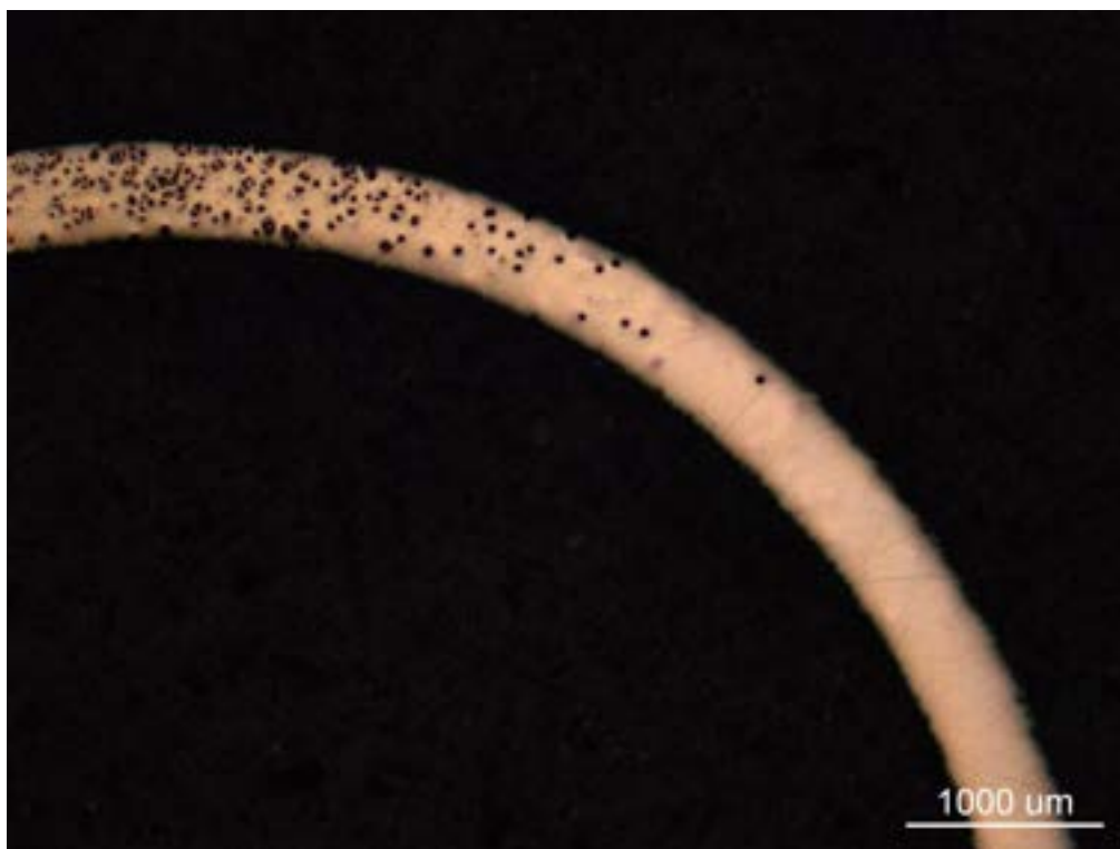
Figura 36 Ingrandimento x25 del tubo di cupronichel dopo immersione in TiCl_4 fino a 500^\circ C
