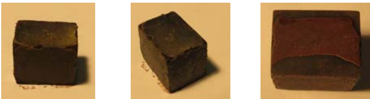
Figura 30 Diverse prospettive del parallelepipedo di P91 introdotti nel cilindro di prova con TiCl_4 fino a 500^\circ C
