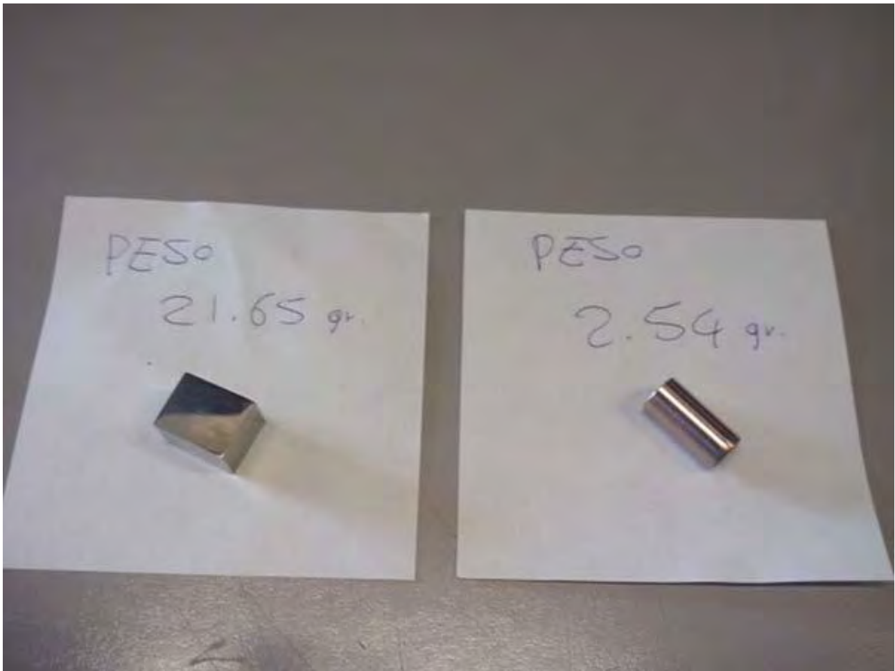
Figura 24 I due provini metallici inseriti nel cilindro, a sinistra il campione di forma parallelepipedica del P91 e a destra un pezzo di tubetto di lega cupronichel
