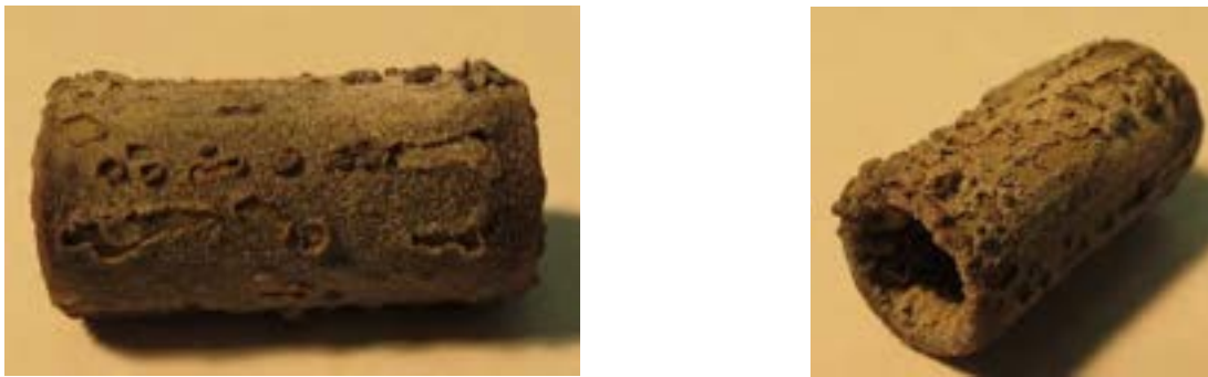
Figura 35 Diverse prospettive del cilindro di cupronichel introdotti nel cilindro di prova con il TiCl_4 fino a 500^\circ C
