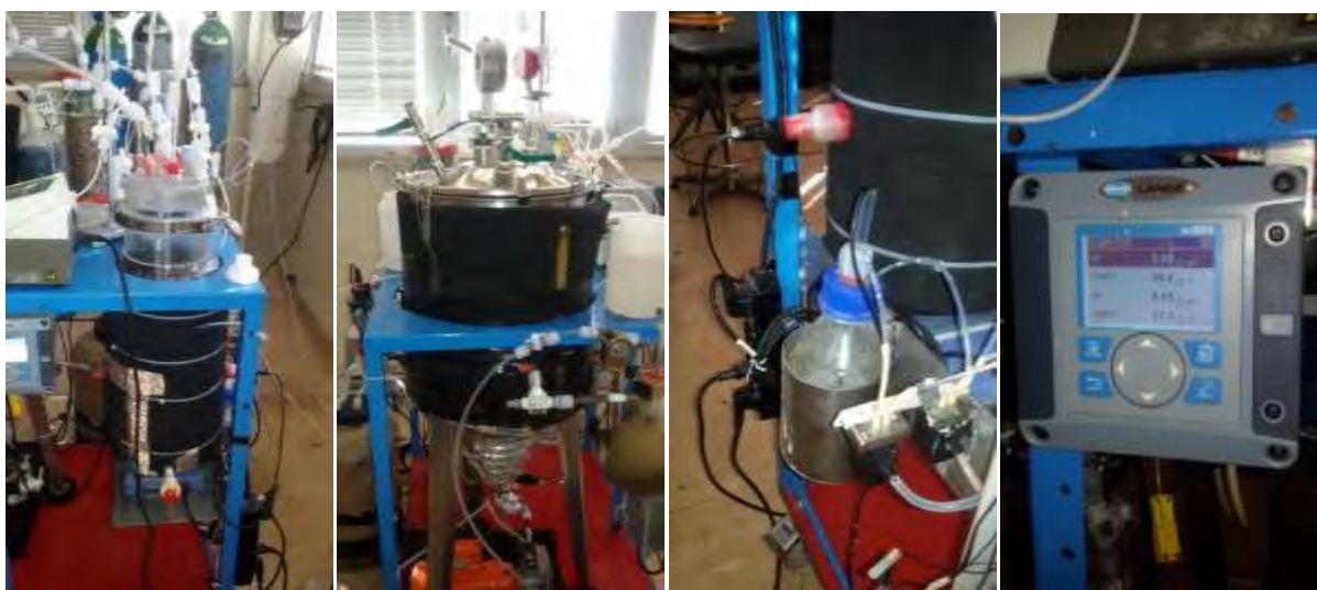
Figura 1. Impianto bistadio: a) reattore 1° stadio (10 L); b) reattore 2° stadio (61 L); c) Controllo in automatico del pH; d) Dispositivo di controllo automatico del pH
