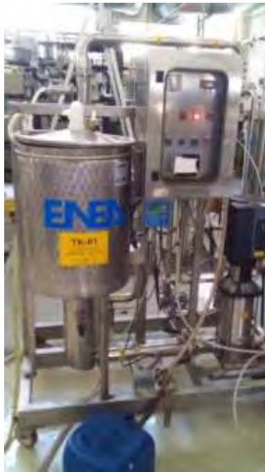
Figura 14. Apparato per filtrazione a membrana e raffronto visivo tra filtrato e risulta
