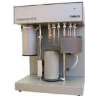
Figura 2. Sorptometer 1040 "Kelvin" della Costech International
