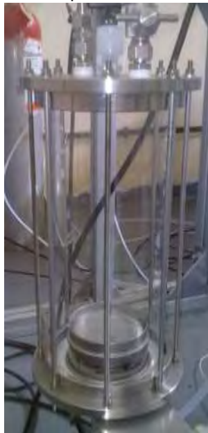
Figura 9. Foto del serbatoio con un layout alternativo a quello testato, diverso diffusore e assenza dei setti
