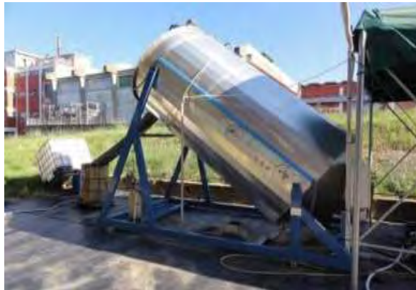
Figura 1. Il digestore anaerobico DM6000
