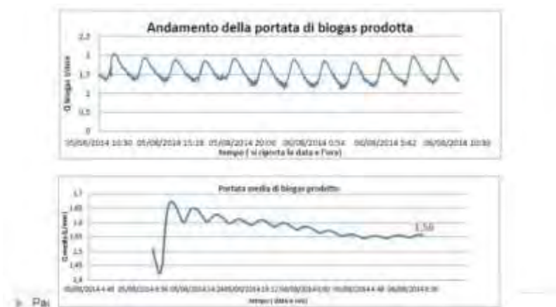
Figura 2. Andamento medio della portata di gas prodotta dal digestore pilota DMM6000
