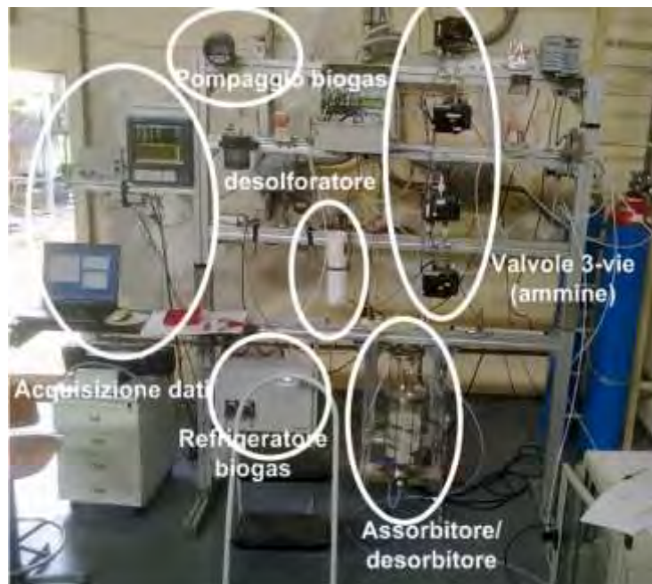
Figura 6. Sistema prototipale di purificazione e upgrading del biogas. Sono evidenziati il reattore per la desolforazione con carboni attivi e uno dei due reattori di assorbimento/desorbimento della CO 2 con soluzione di ammine AMP in glicol etilenico-propanolo
