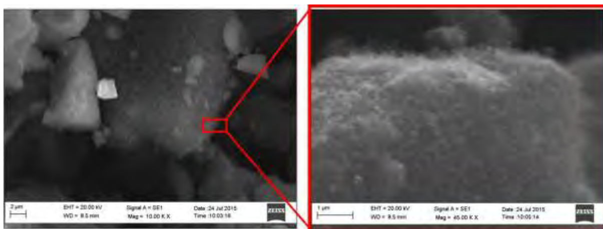
Figura 10. Immagine SEM (a sx), e relativo ingrandimento di un particolare (a dx), relativa ad una particella del campione S-5_650 in cui è evidente la morfologia del C depositato
