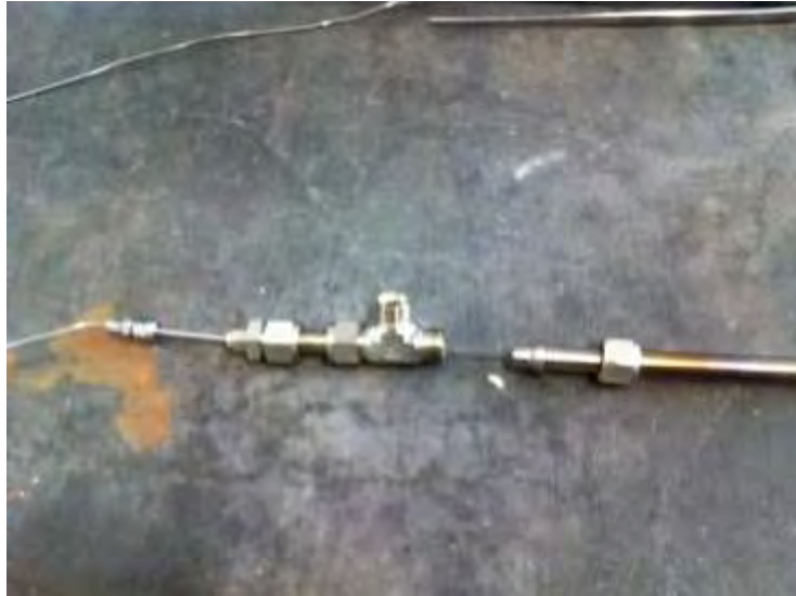
Figura 16. Dettaglio raccordo microreattore termocoppia resa passante
