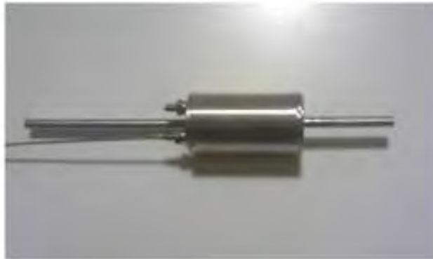
Figura 19. Immagine dell'evaporatore prima della messa in funzione (Poliandri 2014)
