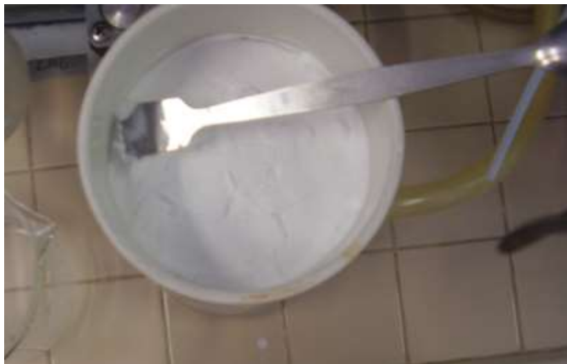
Figura 9. Idrotalcite durante lo step di filtrazione nell'imbuto ceramico per filtrazione
