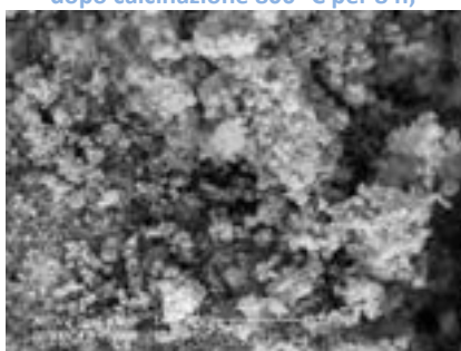
Figura E.77: Immagine SEM ingrandimento (5000X) HT3 dopo calcinazione 800 °C per 8 h;
