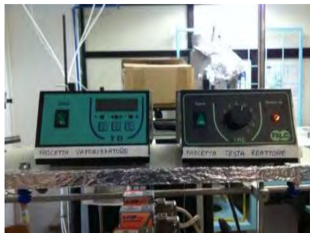
Figura 18. Dettaglio dei due controllori PID delle fascette riscaldanti
