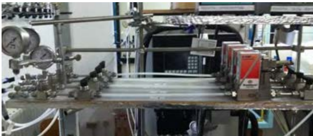
Figura 13. Linee di alimentazione dei gas
