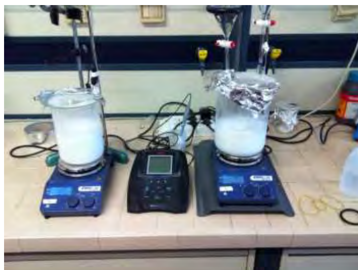
Figura 7. Sintesi di idrotalcite a pH costante
