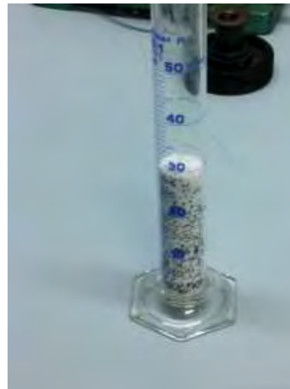
Figura 24. Sorbente e carborundum sono mischiati prima di essere messi all'interno del reattore
