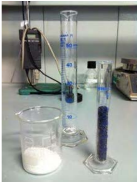
Figura 23. Materiale sorbente e carborundum al 30% prima del test
