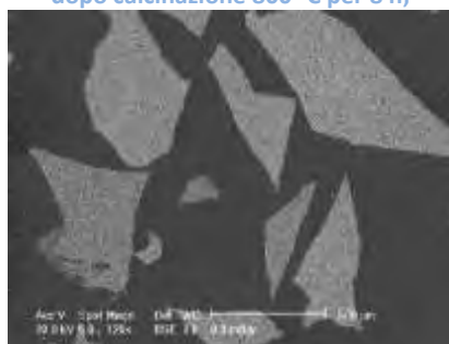
Figura E.78: Immagine SEM ingrandimento (125X) HT3 dopo calcinazione 800 °C per 8 h lappato;
