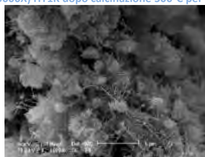
Figura E.6: Immagine SEM a grande ingrandimento (10000X) HT1K dopo calcinazione 500°C per 8 h
