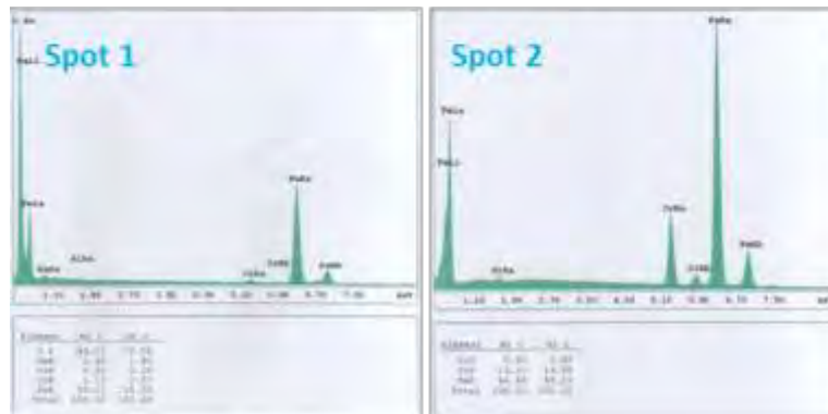
Figura 12. SS 430, dopo 8000 ore a 590 °C: analisi EDS sui due punti indicati nella figura in alto
