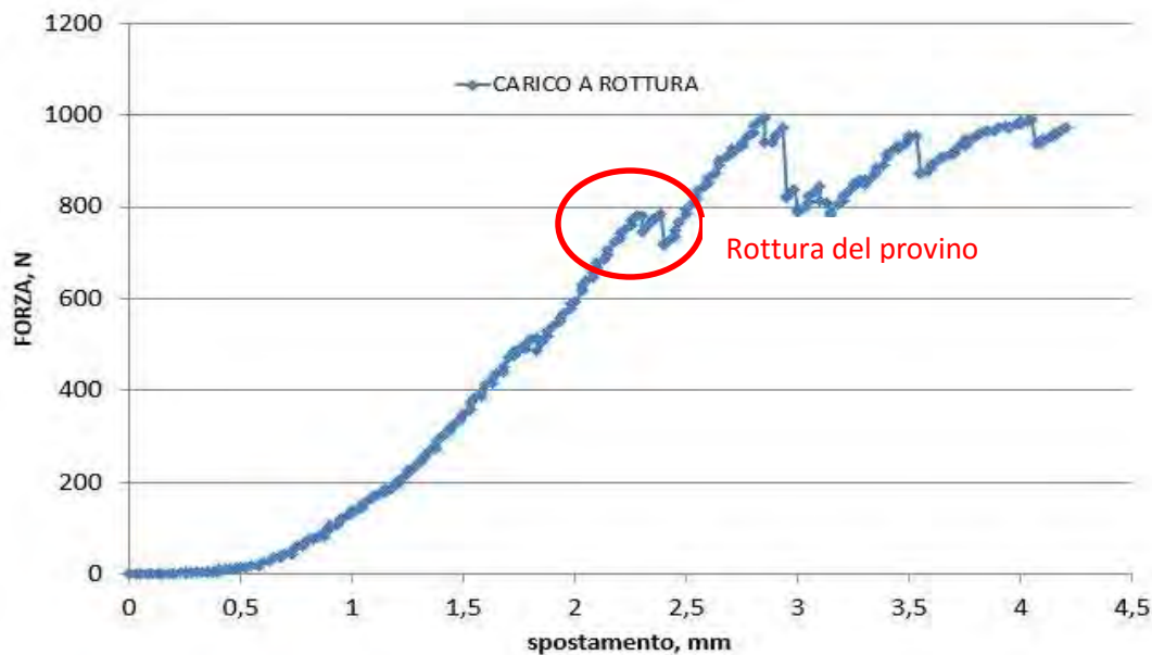
Figura 7. Prova di compressione di un monolite in SiC dopo immersione per 35 minuti nella soluzione acida
