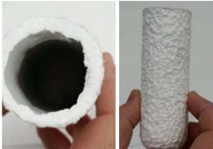
Figura 44. Stato del filtro a ditale dopo due giorni di prove con il filtro D
