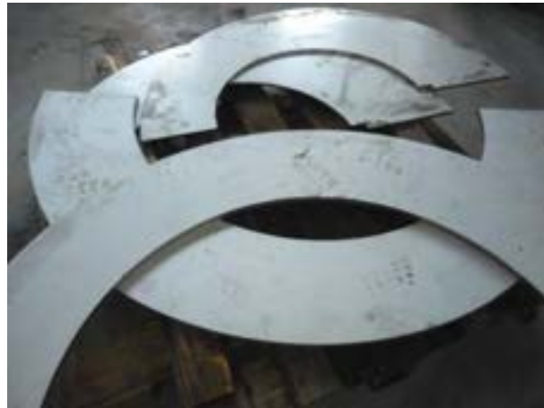
Fig. 2.5. Vista dei dischi di protezione del sistema di movimentazione griglia
