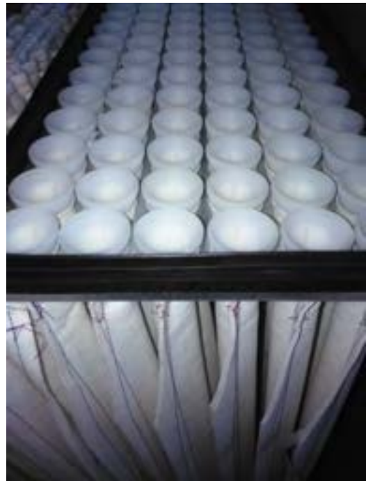
Figura 2.4. Sistema di depolverazione (a sinistra) e dettaglio dei cassettei filtranti (a destra)
