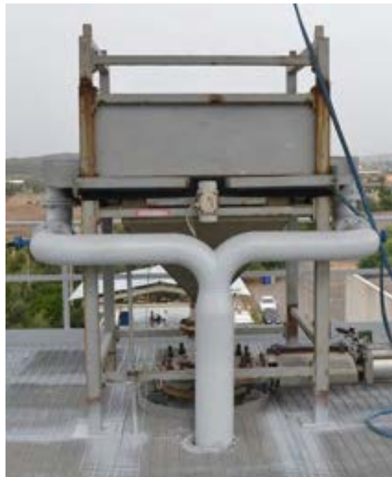
Figura 2.1. Tramoggia del sistema di caricamento del gassificatore
