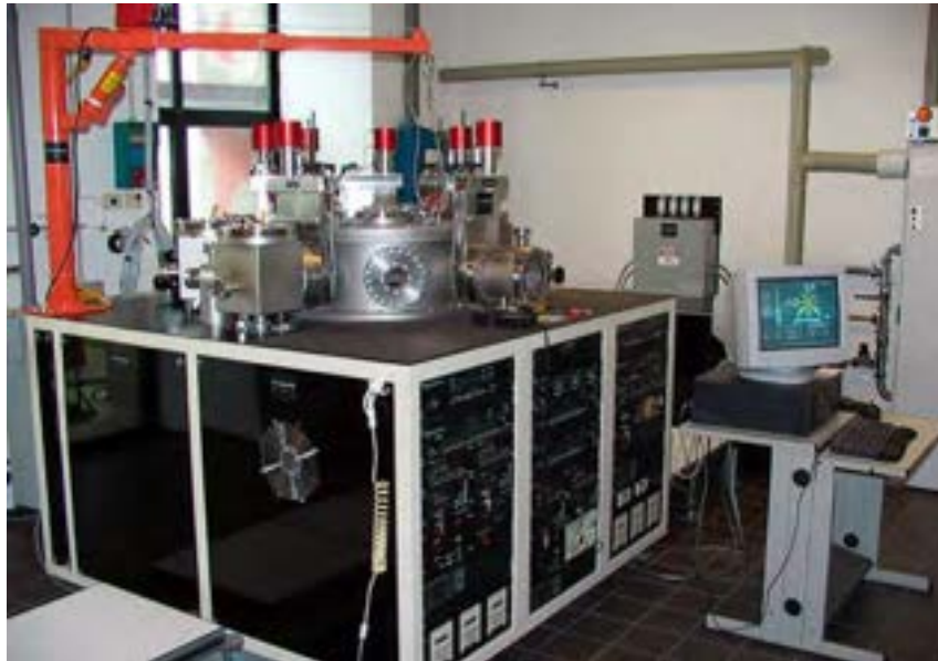
Figura 3.1: Impianto multicamera utilizzato per la fabbricazione di materiali e celle solari in ENEA.
