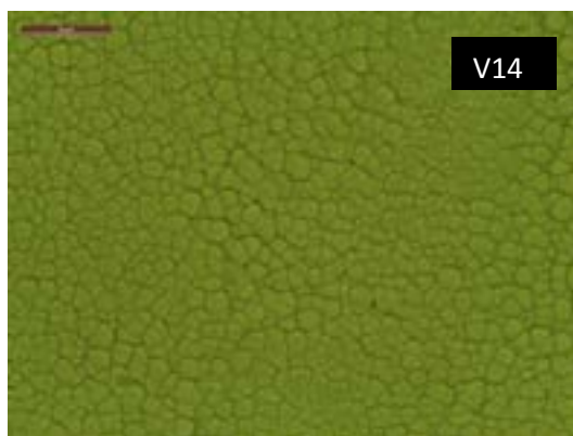
Figura 18. Immagine della superficie testurizzata del vetro di tipo V14. Microscopio ottico in trasmissione, ingrandimento 50X.
