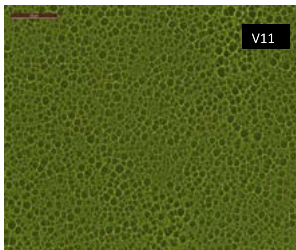
Figura 12. Immagine della superficie testurizzata dei vetri di tipo V11. Microscopio ottico in trasmissione, ingrandimento 50X.
