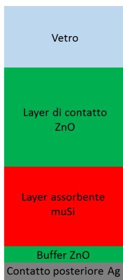
Figura 1. Struttura della cella solare a film sottile di interesse.
