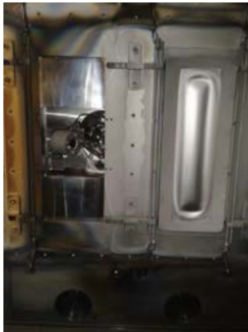
Figura 52. Vista frontale lato vuoto della lastra centrale su cui è installato l'hardware IBAD: sulla sinistra il sistema KRI EH200/HCES inclinato, in fase di messa a punto e testing, a 45° e sulla destra il target del catodo standard magnetron che si vuol far lavorare insieme alla sorgente
