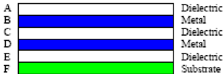
Figura 1. Schema di principio di un assorbitore solare multistrato
