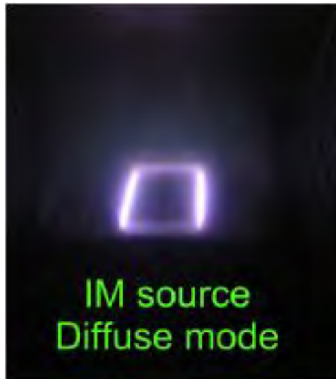
Figura 6. Fascio ionico estratto da una sorgente IM a modalità diffusa
