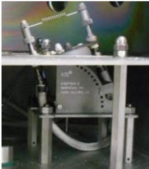
Figura 23. Una delle possibili soluzioni per la movimentazione della sorgente KRI EH200, in fotografia con il neutralizzatore “standard” a filamento
