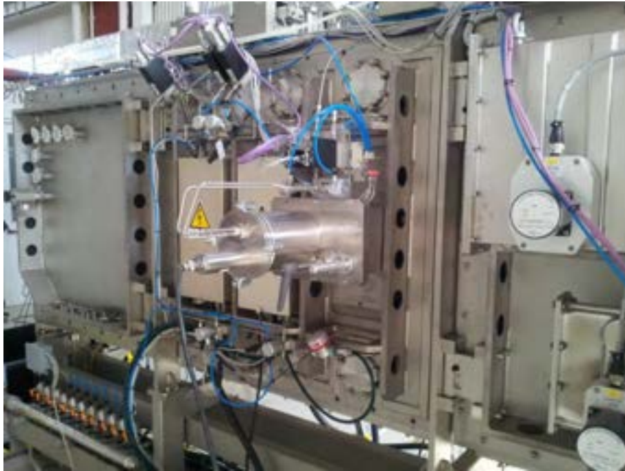
Figura 51. Sezione di deposizione dell'impianto ENEA: in primo piano l'interflangia per l'installazione della sorgente KRI EH200/HCES, l'adduzione gas ed aria compressa e la maniglia per la traslazione della sorgente
