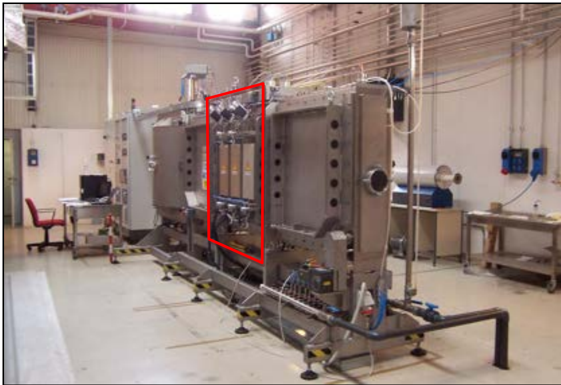
Figura 13. Vista generale dell'impianto di sputtering multi-catodo dell'ENEA con evidenziata la sezione di deposizione
