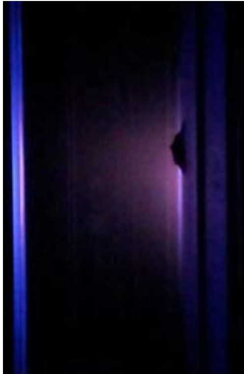
Figura 58. Fascio ionico della sorgente KRI-EH200 installata sull'impianto di sputtering durante i test di collaudo finale come visibile dalla finestra della camera di deposizione
