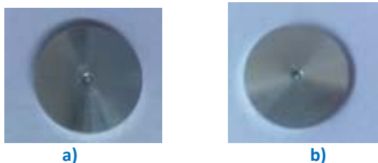
Figura 8- Provino di alluminio prima del test di corrosione (a), dopo il test in KNO 3 (b).
