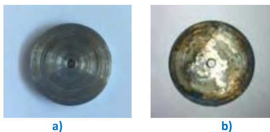
Figura 9- Provino di acciaio al carbonio prima del test di corrosione (a), dopo il test in KNO 3 (b).
