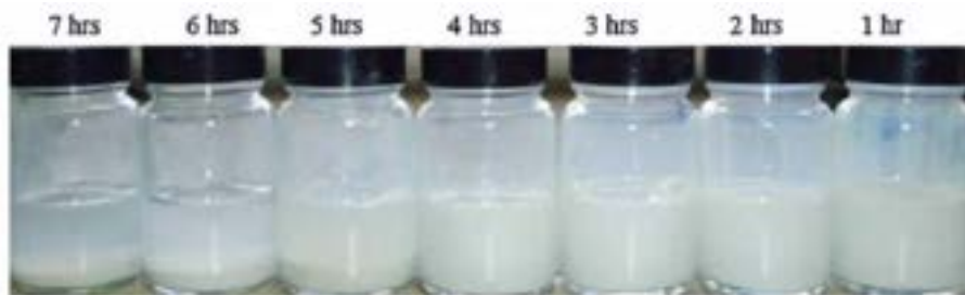
Figura 15- Campioni di nanofluidi con Al 2 O 3 (senza alcuno stabilizzatore: la stabilità cambia nel tempo) 11
