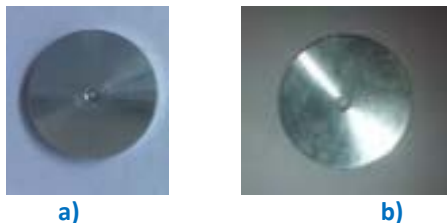
Figura 2- Provino di alluminio prima del test di corrosione (a), dopo il test in \text{NaNO}_3\text{-KNO}_3 (b).
