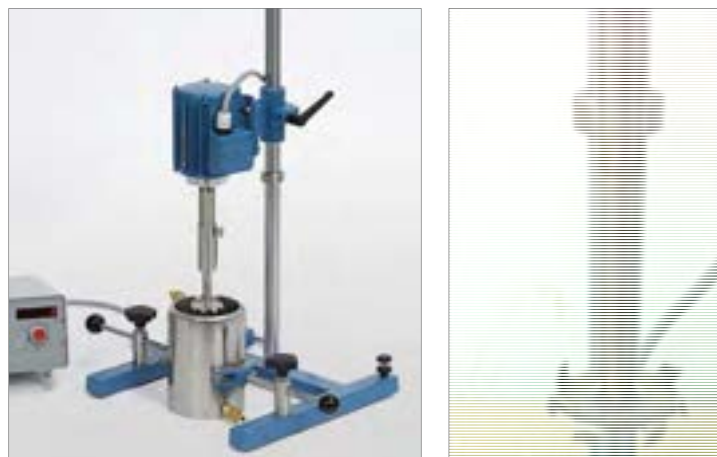
Figura 3- a) miscelatore Dispermat b) testina utilizzata.
