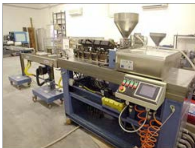
Figura 2- Estrusore bivate modello MD30 della Bausano
