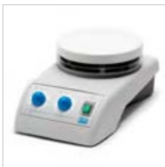
Figura 4- piastra riscaldante con agitatore magnetico.
