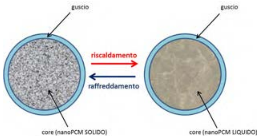
Figura 14 Microcapsule di nanoPCM con un solo guscio.
