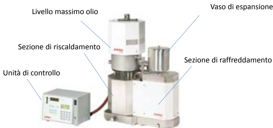
Figura 109: termostato di circolazione.
