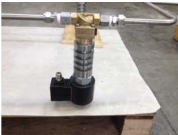
Figura 101: valvola con attuatore elettrico e raccordi.
