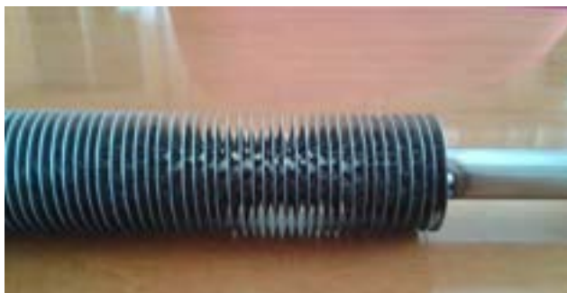
Figura 15 – Esempio di tubo alettato da inserire all’interno di un contenitore (guscio) cilindrico
