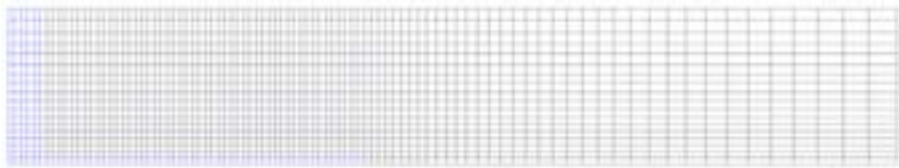
Figura 28- Caso B: Geometria di calcolo e discretizzazione FEM
