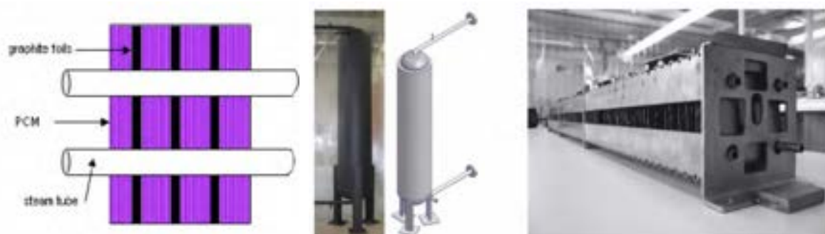
Figura 8 – Applicazione del concetto di LHTES sandwich: schema, modulo di prova, modulo per sistemi LHTES [6][8][10]
