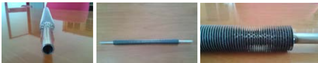
Figura 25- Tubo alettato utilizzato per la realizzazione degli elementi base di accumulo a calore latente
