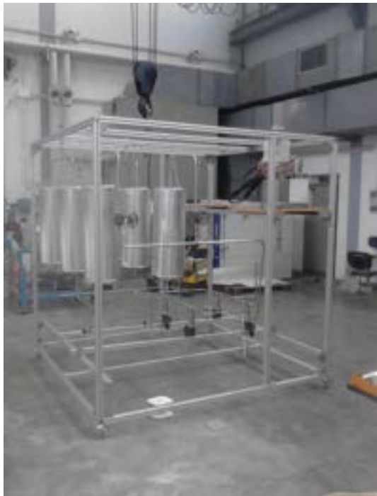
Montaggio degli accumulatori e delle tubazioni
