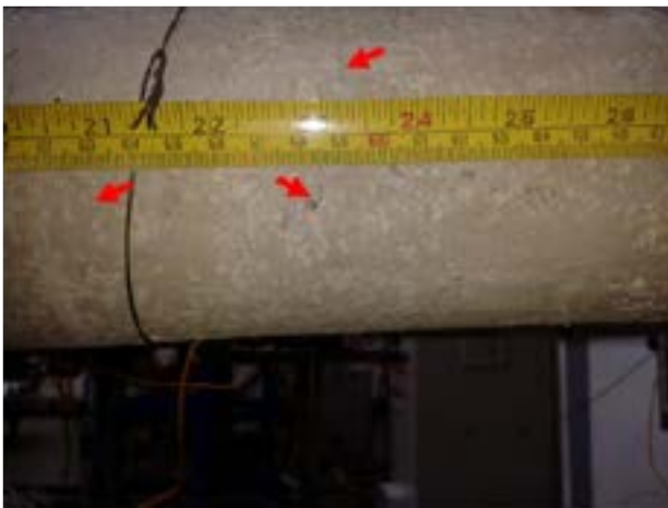
Figura 16- Quadro fessurativo elemento 2 a caldo durante test di degasaggio.
