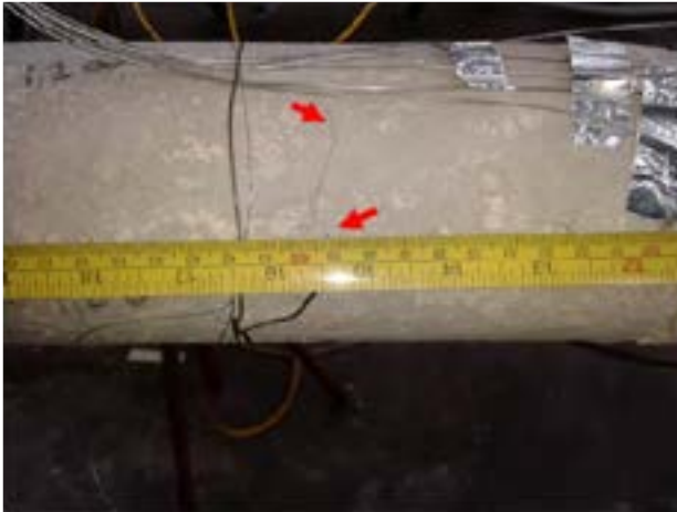
Figura 15- Quadro fessurativo elemento 1 a caldo durante test di degasaggio.
