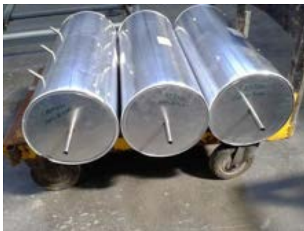
Figura 26- Terza di accumulatori a calore latente con coibentazione e lamierino esterno
