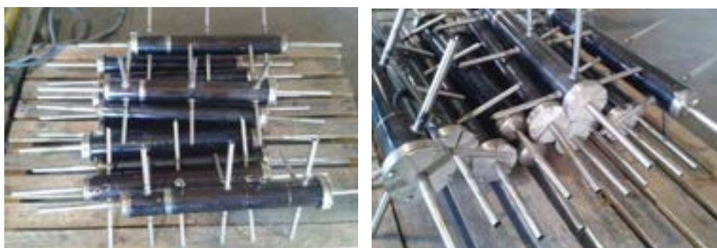
Figura 24- Accumulatori termici elementari prima della coibentazione
