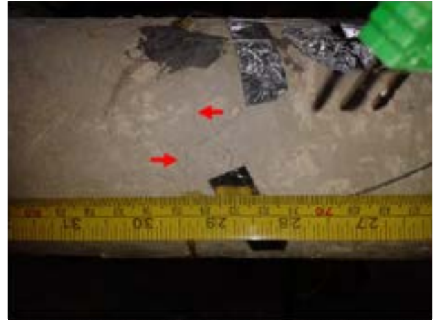
Figura 15- Quadro fessurativo elemento 1 a caldo durante test di degasaggio.
