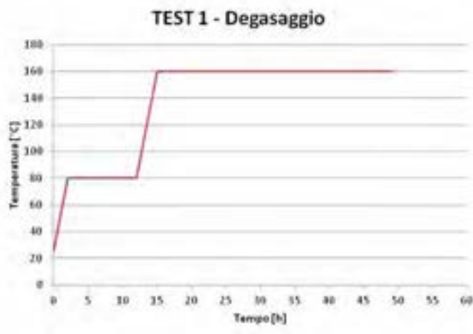
Figura 6 Andamento della temperatura erogata dal riscaldatore nel Test-1 di degasaggio.
