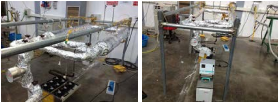
Figura 1 Impianto prova elementi di accumulo SolTeCa 1.
