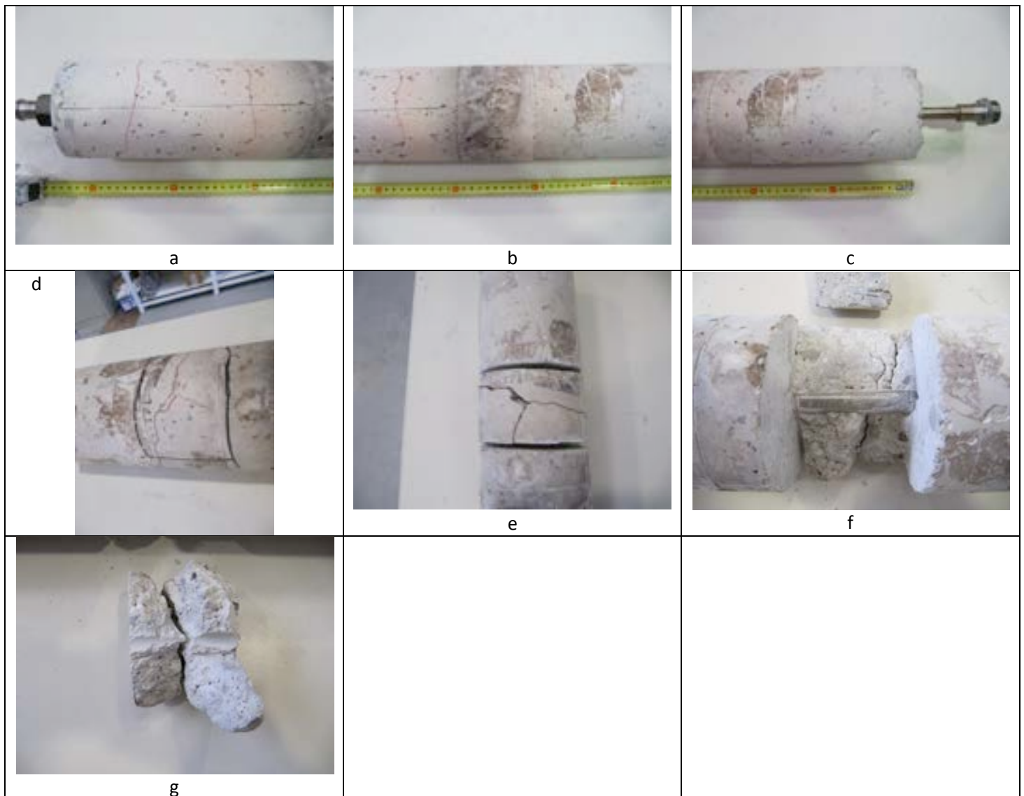
Figura 18 – Immagini riguardanti l’elemento 4 dopo la campagna sperimentale.
